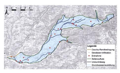
Fig. 4: Randbedingungen des Grundwassermodells.
