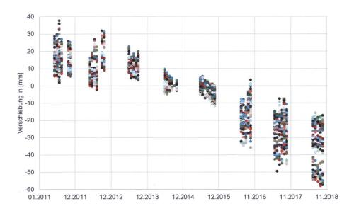
Fig. 12: Verschiebungszeitreihe für Punkte im Bereich der Abbruchstelle aus dem descending Orbit (T016D). Die Verschiebung ist in Blickrichtung des Radars angegeben.
