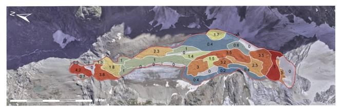
Fig. 10: Geschätzte, mittlere Ablagerungsmächtigkeit in Meter in verschiedenen Teilbereichen des Transitund Ablagerungsgebiets.
