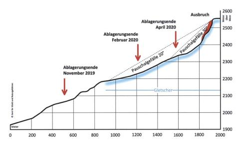
Fig. 11: Längenprofil entlang des Prozessraums (Grafik: Abteilung Naturgefahren).
