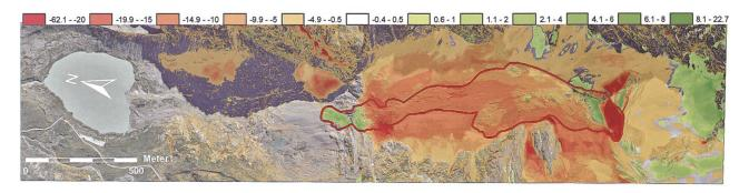
Fig. 7: Höhendifferenz zwischen Swissalti3d und Höhenmodell 2020 in Meter.
