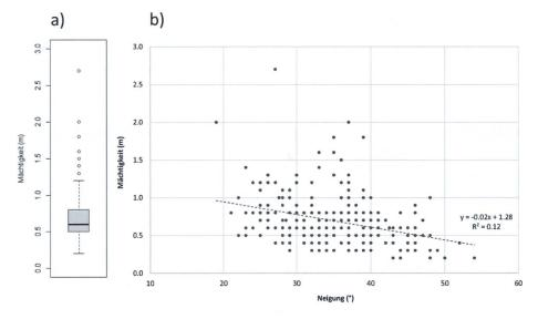
Fig. 5: a) Werteverteilung der gemessenen (mittleren) Mächtigkeiten der dokumentierten Rutschungen. b) mit zunehmender Neigung der Rutschungen wurden tendenziell kleinere Anrissmächtigkeiten beobachtet.
