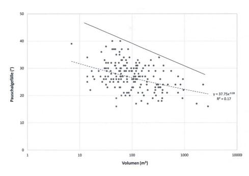
Fig. 7: Zusammenhang zwischen Pauschalgefälle und Volumen der Rutschungen in der Datenbank (n = 185). x-Achse mit logarithmischem Massstab; ausgezogene Linie: Umhüllende maximale Pauschalgefälle, unterbrochene Linie: Regressionslinie.
