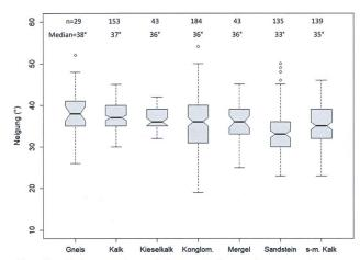
Fig. 3: Neigungsbereiche von Rutschungen in verschiedenen Hauptlithologien (Konglom. = Konglomerate, s-m. Kalk = schiefriger bis mergeliger Kalk, n = Anzahl Rutschungen).
