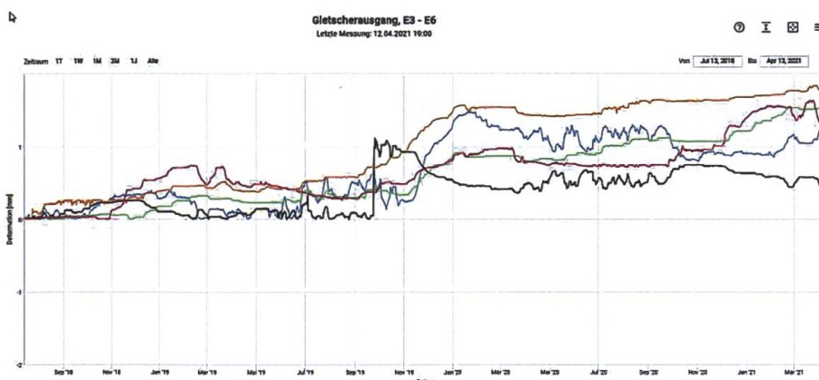
Fig. 12: Ausschnitt der Aufzeichnung der Messresultate der Extensometer.
