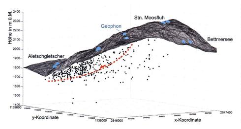
Fig. 7: Lokalisierte Events in einer 3D-Darstellung mit Blick in Richtung NE. Die Seitenansicht verläuft von NNW (links, Aletschaletscher) nach SSE (rechts, Bettmersee). Die blauen Punkte auf der Felsoberentsprechen fläche Geophonen. Jeder schwarze Punkt stellt ein lokalisiertes mikroseismisches Event dar. Der mögliche basale Abscherhorizont der Rutschmasse ist rot gestrichelt dargestellt.
