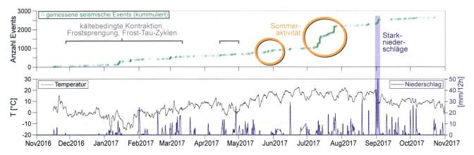
Fig. 6: Mikroseismische Aktivität «Im Ruostel» im Jahr 2017, ausgewertet mit tieferem Signal to Noise Ratio.
