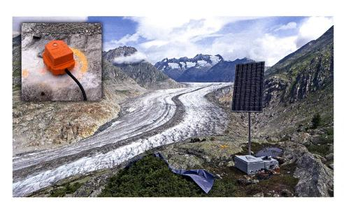
Fig. 3: Eine Station mit Logging- und Datenübertragungs-Einheit, sowie Stromversorgung oberhalb des Aletschgletschers mit Geophon (links), bevor dieses eingesandet und Schallschutz-geschützt ummantelt wurde.
