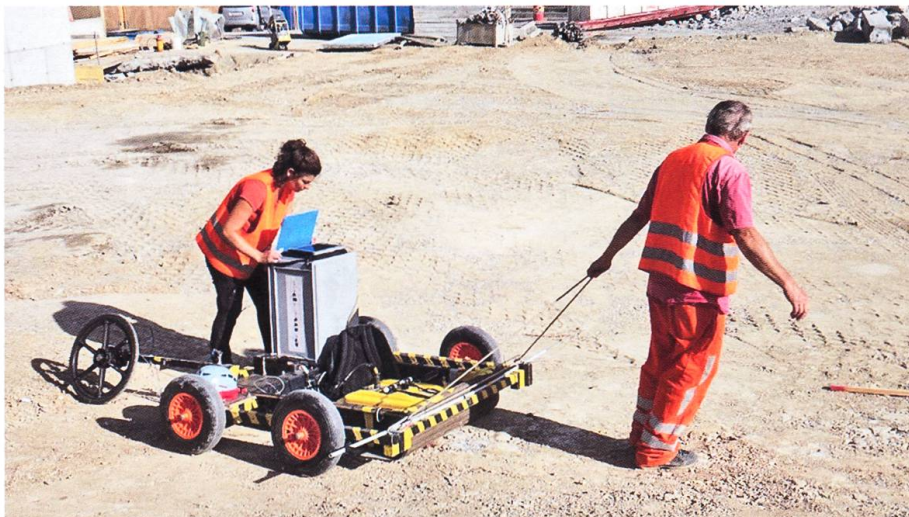
Fig. 8: Das Georadar-Equipment in Aktion (Bild Th. Rüegg, 15.08.2017).
