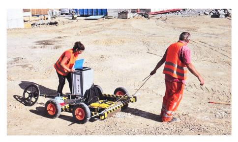
Fig. 8: Das Georadar-Equipment in Aktion (Bild Th. Rüegg, 15.08.2017).
