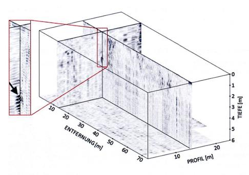
Fig. 10: Dreidimensionale Darstellung der Radardaten. Aufgenommen wurden Längsprofile. Querprofile und Ebenen wurden interpoliert.
