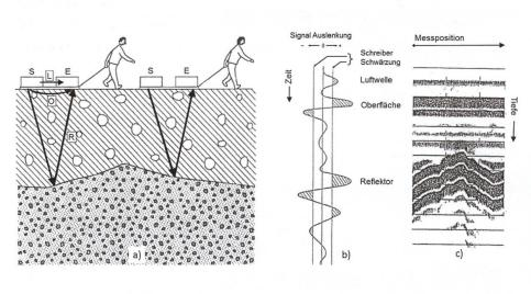
Fig. 7: Messprinzip (Bild aus Meier & Huggenberger 1992, modifiziert): a) elektromagnetischer Puls wird vom Sender (S) ausgestrahlt. Ändert der elektrische Widerstand, wird das Signal reflektiert und vom Empfänger (E) aufgenommen. Das Radar wird zur nächsten Messposition weitergezogen; b) Empfangssignal bei der Empfangsantenne; c) Aneinanderreihung der Empfangssignale ergibt Radargramm.
