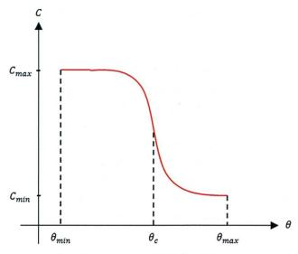
Fig. 3: Représentation schématique de l'évolution de la cohésion en fonction de la teneur en eau.
