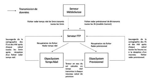
Fig. 10: Schéma de l'organisation des modules Olpac temps réel et prévisionnel (FS: coefficient de sécurité, HW: hauteur de sol saturé).
