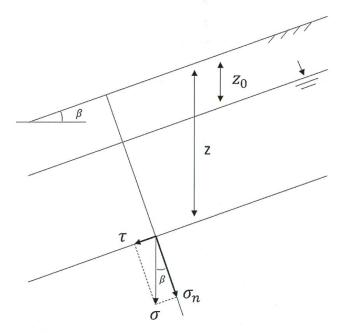
Fig. 2: Schéma permettant d'établir les différentes résistances mises en jeu lors d'un glissement plan infini. Avec  $\sigma_n$  permettant de calculer la résistance maximale mobilisable et  $\tau$  représentant la résistance utile.
