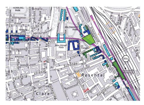
Fig. 2: Geplantes Trasse des Rheintunnels mit bestehenden Nutzungen des Untergrunds (Keller, Bohrungen).
