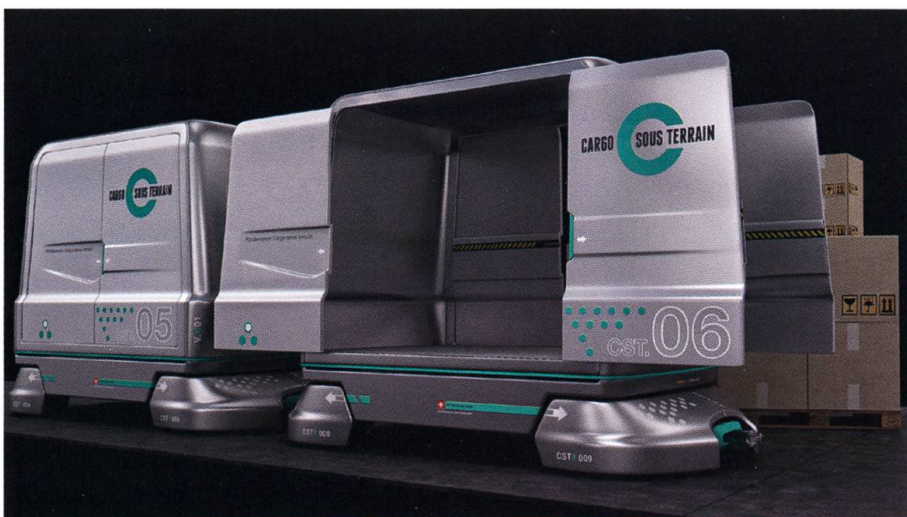
Fig. 4: Visualisierung der CST-Transportfahrzeuge mit Ladungsmodulen für 2 Europaletten.
