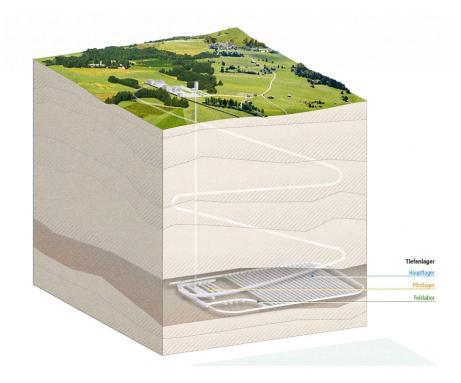
Fig. 2: Modellvorstellung eines geologischen Tiefenlagers (Eidgenössisches Nuklearsicherheitsinspektorat ENSI).
