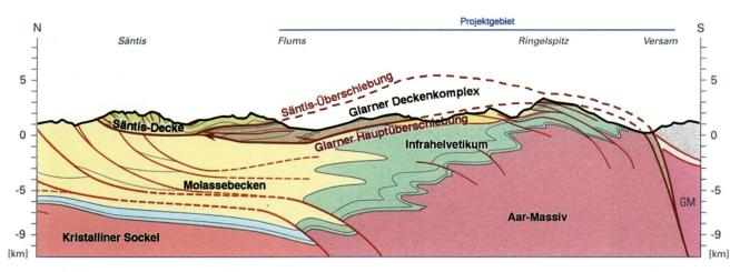
Fig. 3: Geologischer Nord-Süd-Profilschnitt im Bereich des Projektgebiets mit tektonischen Einheiten (vereinfacht nach Pfiffner, 2009).
