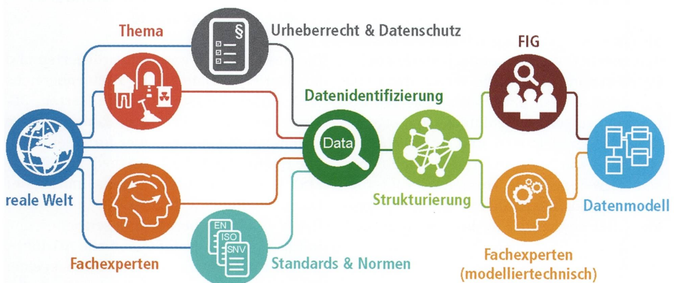
Fig. 1: Entwicklungsprozess eines Datenmodells: Zur Modellierung eines Themenkreises der realen Welt werden das Wissen der Fachexperten, bestehende Standards und Normen sowie rechtliche Aspekte berücksichtigt. Die identifizierten Daten werden strukturiert und anschliessend fachlich (FIG = Fachinformationsgemeinschaft) als auch modelliertechisch auf ihre Korrektheit überprüft.
