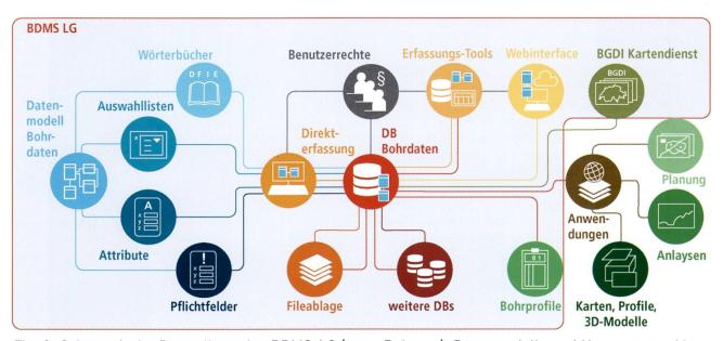
Fig. 2: Schematische Darstellung des BDMS-LG (roter Rahmen). Datenmodelle und Umsetzung = blau, Datenintegration = gelb bis orange, Benutzerrechte = grau, Schnittstellen zur Datenbank (DB) Bohrdaten= orange bis rot, Anwendungen = braun, Produkte = grün.
