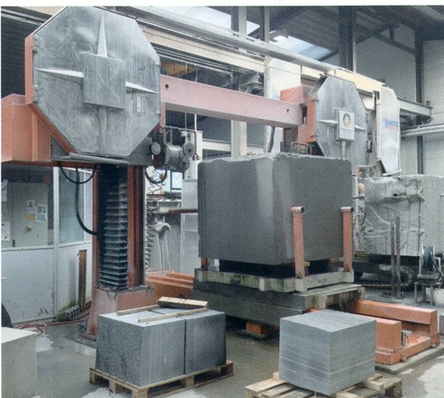
Fig. 10: CNC-gesteuerte Diamant-Seilsäge im Verarbeitungswerk Bäch (Typ CANDIANI CNC).
