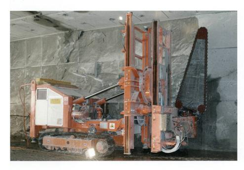
Fig. 8: Mobile, elektrische Ketten-Schrämmmaschine (Typ FANTINI SUD Segatrice GU70).
