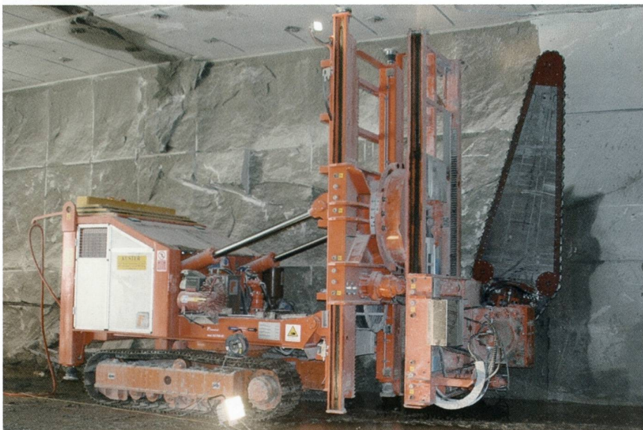
Fig. 8: Mobile, elektrische Ketten-Schrämmmaschine (Typ FANTINI SUD Segatrice GU70).
