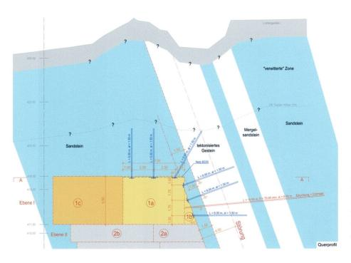
Fig. 7: Vortriebskonzept im Querprofil: Zuerst wird der Startstollen (1a) ausgebrochen und seitlich aufgeweitet (1b) (1c). Danach werden die nächsten Etappen im Abteufverfahren abgebaut (Bergamin & Kessler, 2011).
