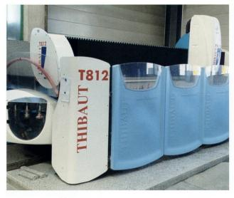
Fig. 11: CNC-gesteuertes Bearbeitungszentrum (Typ THIBAUT T812).
