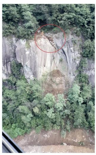
Fig. 9: Blick aus der Luft auf die Sprengstelle (roter Kreis), die Sturzbahn und den provisorischen Schutzdamm. Im Schutzdamm liegen einzelne grössere Sturzblöcke.
