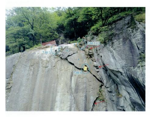
Fig. 3: Detailaufnahme der instabilen Felsplatten (nach Entfernung der Lockergesteinsüberdeckung): Die roten Pfeile zeigen die Lage der offenen Hauptkluft im Süden des grossen massigen Felskompartimentes (links). Die blauen Kreise weisen auf die Lage und Nummern der Telejointmeter (TJM) hin. Mit den Sternen sind die vier wichtigsten instabilen Felsplatten bezeichnet.
