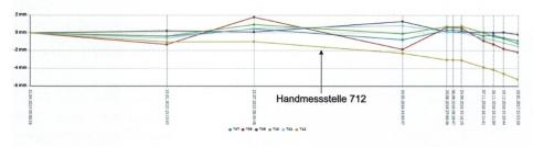
Fig. 4: Die Ganglinie der Handmessstelle Nr. 712 - an der Hauptkluft zwischen dem stabilen Felsverband und den labilen Felsplatten angebracht – zeigt eine leicht beschleunigende Deformationstendenz.
