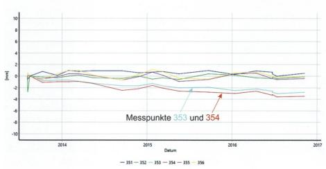
Fig. 5: Die Ganglinien der tachymetrischen Messpunkte Nr. 353 und Nr. 354 (unten) weisen auf eine talwärts gerichtete Bewegung des grossen Felskomplexes in den letzten drei Jahren von rund 3 mm hin.
