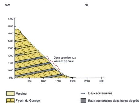
Fig. 9: Coupe géologique schématique du versant d'Eltschingera.
