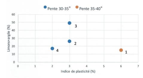
Fig. 13: Graphique Indice de plasticité – teneur en fines dans la zone source de St. Antönien. Situation: voir figure 12. Le point no 4 concerne une autre coulée de boue un peu plus bas dans le versant.
