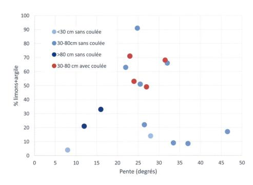
Fig. 6: Corrélation entre granulométrie, épaisseur des formations superficielles, pente du versant et occurrence de coulées de boue (zone instable).
