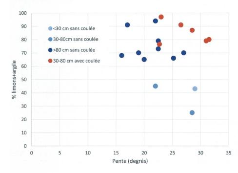
Fig. 10: Eltschingera: Corrélation entre granulométrie, épaisseur des formations superficielles, pente du versant et occurrence de coulées de boue.
