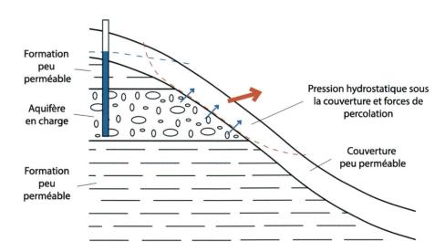
Fig. 2: Effet du contraste de perméabilité entre le substratum et la couverture.
