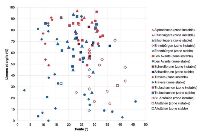
Fig. 11: Synthèse des mesures sur les sites étudiés. En rouge, les échantillons prélevés dans les zones instables. En bleu, ceux des zones stables. D'après Wyss et al. 2018.
