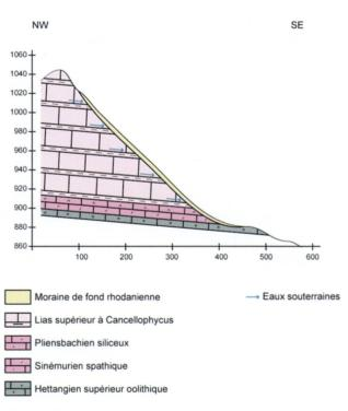
Fig. 5: Coupe géologique schématique du versant des Avants.
