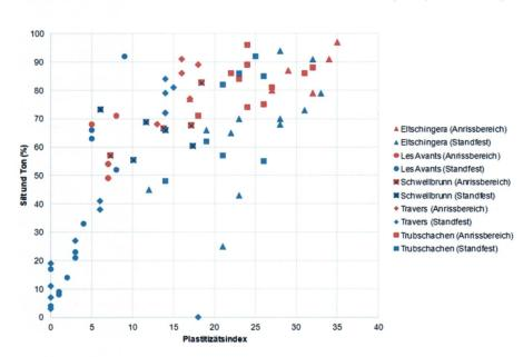
Fig. 3: Gebiete mit flächiger Fragestellung: Diagramm Plastizitätsindex versus Siltund Tongehalt. Rot: Probe aus Anrissbereich, Blau: Probe aus dem standfesten Untergrund.
