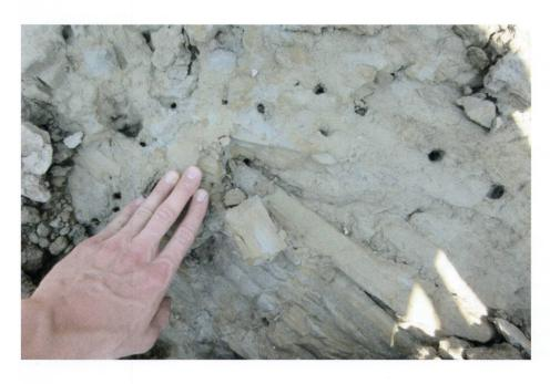
Fig. 1: Bergwasser- oder Hangwasserzutritte hinterlassen Löcher auf der Gleitfläche im Anrissgebiet (verwitterte Mergel) der Hangmure (Schwellbrunn; Foto: B. Stricker).
