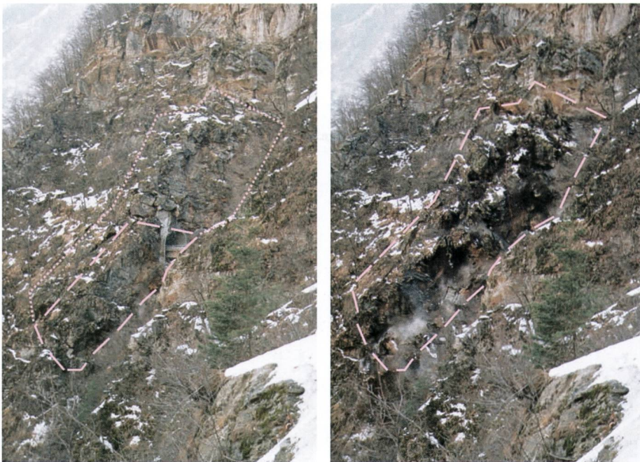
Fig. 5b: Im «Kipp/Gleit»-Prozess erfolgt das Versagen als erstes in der Kriech- oder Bruchzone in dem im Feld meist kaum lokalisierbaren Fuss der Sturzmasse. Die in der Folge hängende Ablösezone folgt dem Sturzereignis hinterher (Val d'Infern [6]).
