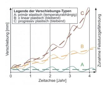
Fig. 9a: Mit Hilfe eines Beurteilungsflowcharts kann entsprechend den verschiedenen Verschiebungscharakteristiken von Felssturzdispositionen eine zielgerichtete, kosten-/risikooptimierte Massnahmenplanung vorgenommen werden. Die oberflächennah, temperaturbedingt gemessenen, saisonalen Verschiebungsperiodizitäten sind entsprechend zu berücksichtigen.
