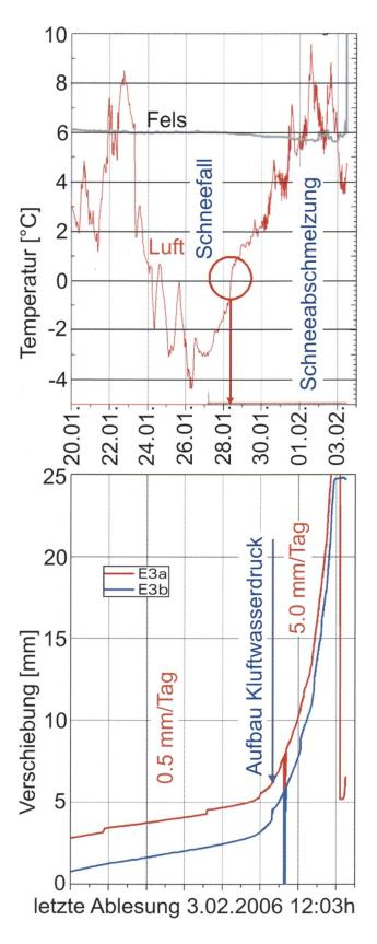
Fig. 4: Kluftwasserdruck infolge des Abschmelzens frisch gefallenen Schnees kann in der kalten Jahreszeit die Verschiebungsgeschwindigkeiten bis um Faktor 10 erhöhen. Dies führte im Val d'Infern 5 Tage nach Beginn der Tauphase am 3. Februar 2006 als Trigger zum Absturz von 20'000 m³ Fels (E: Extensometer [6]).
