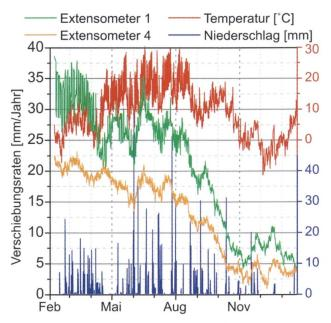
Fig. 2: Extensometerverschiebungen in duktil sich verhaltendem Bündnerschiefer lassen keine eindeutigen Abhängigkeiten von Temperatur und Niederschlag erkennen, Ricaldei, Tschiertschenstrasse (nach Kopfentlastung mittels Felsabtrag sind die Verschiebungen seit 2001 generell abnehmend [5]).
