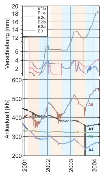
Fig. 8: Ankerkräfte können als redundantes Messsystem das zyklische Verhalten der Verschiebungsmessungen bestätigen. In Poschiavo korrelierten die über 3 Jahre in der kalten Jahreszeit (blau) gemessenen Verschiebungsschübe sowie die sommerlich rückläufigen (rot), elastischen Verformungen der in Bohrlöchern versetzten Extensometer E1a bis E3 mit den Ergebnissen der im Fels vorgespannten Anker A1 bis A5 [2].
