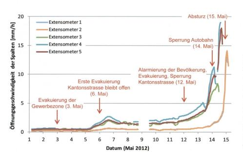
Fig. 2: Alarmsystem im Rutschgebiet Preonzo, Kt. Tessin. Die Extensometer 1-5 wurden in der Anrisszone installiert und zeigen die Beschleunigung zwischen dem 5. und 15. Mai 2012. (Quelle: Löw [ETHZ] und Valenti [Kanton Tessin], 2014, persönliche Mitteilung; Daten der Extensometer: Amt für Wald, Kanton Tessin).
