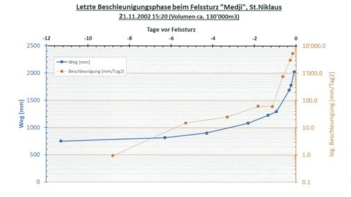
Fig. 3: Bewegungsvektor und Beschleunigung eines Reflektor-Messpunktes in der Endphase des Felssturzes Medji, St. Niklaus VS (Rovina+Partner AG).
