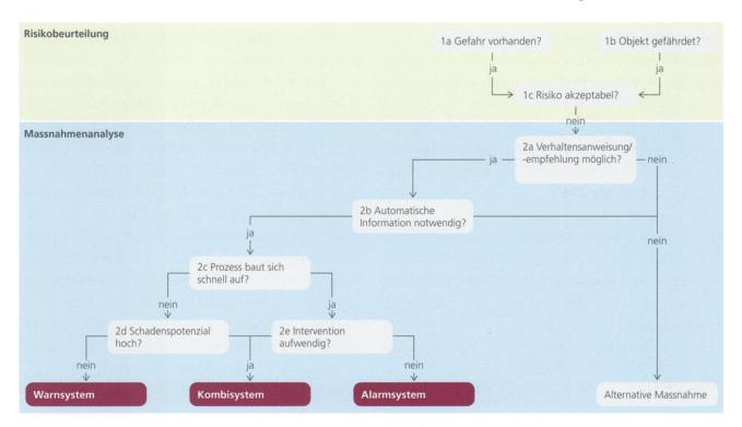
Fig. 1: Entscheidungsdiagramm für die Wahl des FWS-Typs (aus BABS 2015).
