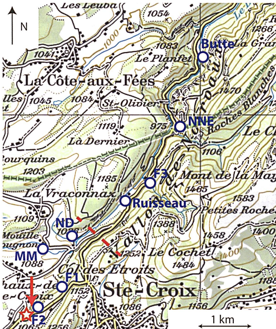
Fig. 1: Carte de situation. Etoile rouge: décharge. Flèche rouge: déversement des traceurs au pied de la décharge. Cercles bleus: points d'échantillonnage de l'essai de traçage (F1, F2 et F3: forages profonds, MM: Source de Mouille-Mougnon, ND: source Noirvaux dessus, NNE: source non captée Noirvaux-Neuchâtel, Butte: source de la Longeigue du village de Butte. Traitillé rouge: profil géologique de la figure 2. Reproduit avec l'autorisation no JA110138 de Swisstopo.
