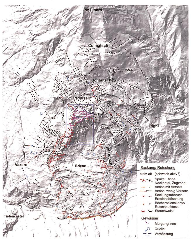
Fig. 6: Geomorphologische Kartierung mit «aktiven» und «alten» Strukturen der Massenbewegung, hinterlegt mit der Reliefschattierung aus dem DTM [3]. Die alten Strukturen erstrecken sich weit über das aktive Rutsch- und Felssturzgebiet hinaus (Rechteck Studienperimeter Masterarbeit A. Ludwig [1]).
