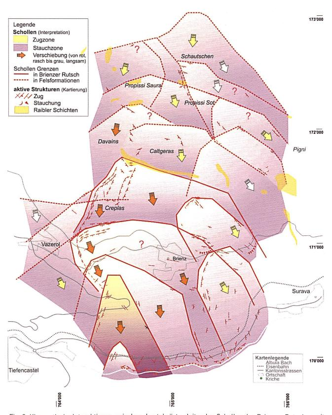
Fig. 9: Kinematische Interaktionen zwischen den talwärts gleitenden Schollen des Brienzer Rutsches mit stets sich verändernden Zug- und Stauchzonen und den «aktiven» Auswirkungen bis in die Felsschollen von Propissi und Schautschen auf ~ 1800 m ü.M.
