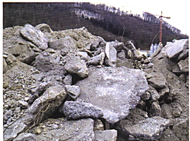
Fig. 3: Betonabbruch mit leichter Armierung (Foto: D. Hiltbrunner).
