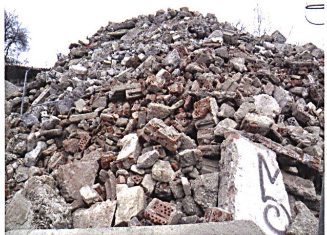
Fig. 2: Mischabbruch aus Gebäuderückbau (Foto: D. Hiltbrunner).
