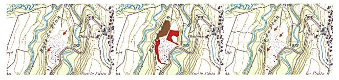
Fig. 2: Beispiel von Veränderungen von Abbauflächen in der Landeskarte. (Blatt 1203 Yverdon-les-Bains). Braun: Vergrösserung einer Kiesgrube; rot: Rekultivierung. Bild links: Landeskarte alt: (1992, Datenstand 1990); Bild Mitte; Veränderungen; Bild rechts: Landeskarte neu: (1999, Datenstand 1997). Quelle: ARE/BAFU 2007.
