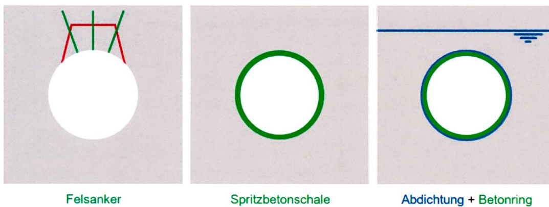
Fig. 2: Einwirkung und Auswirkung im Untertagbau.
