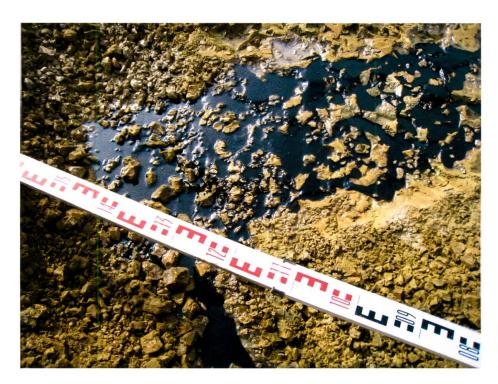
Fig. 7: Polluants en phase liquide lourde au toit de la molasse marneuse.
