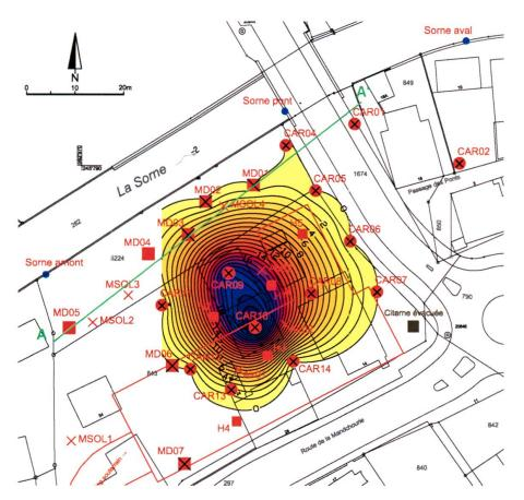
Fig. 1: Carte d'iso-teneurs en Benzo(a)pyrène dans la nappe [μg/l], avec le «hot spot» en CAR09 et CAR10 sous l'ancien bâtiment de l'usine à gaz (A-A`: trace du profil de la figure 4).
