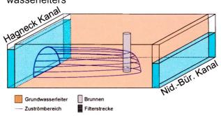
Fig. 3: Konzeptuelles Modell der Zuströmbereiche für die aktuelle Konfiguration der Fassung und die zwei Modifikationsvorschläge. Modifiziert nach Gobat 2015.
