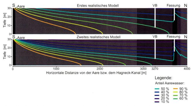
Fig. 7: Verteilung der Aarewasserkonzentration entlang eines vertikalen Längsschnitts durch den neuen Versuchsbrunnen und die Trinkwasserfassung der Gemeinde Kappelen. Modelleingaben gemäss Tab. 2. Modifiziert nach Gobat 2015.
