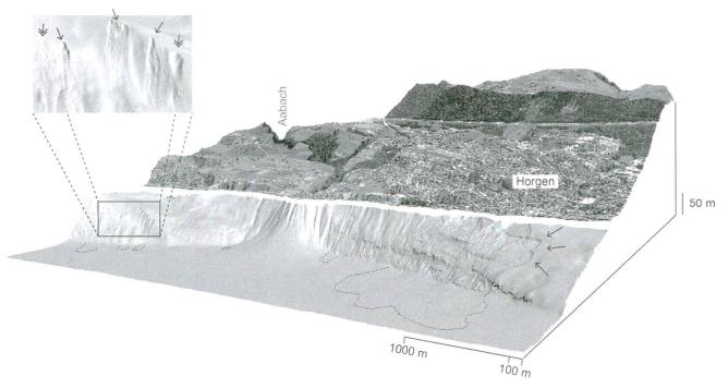
Fig. 3: Rutschung vor Horgen von 1875 und Delta des Aabachs. Darstellung 3× vertikal überhöht. SwissAlti3D-Geländemodell und überlagerte Swissimage50 Orthophotos (Swisstopo). Einfache Pfeile: scharfe Anrisszonen; Pfeile mit doppelter Spitze: unscharfe Anrisszonen.
