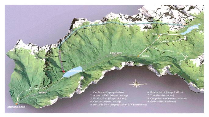
Fig. 1: Talansicht Val Poschiavo Westflanke. Repower AG Poschiavo 2015. Triebwasserschema der bestehenden Produktionsanlagen der Kraftwerke Palü, Cavaglia und Robbia sowie Campocologno I und II (weisse Linien: Druckleitungen ausgezogen, Überleitstollen punktiert). Pumpspeicherkraftwerk Lagobianco (blaue Punktlinien: Druckstollen und -schacht), Anlagenteile siehe Legende.
