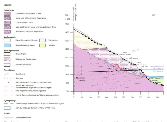
Fig. 9: Längsprofil Maschinenkaverne – Ein- und Auslaufbauwerk Lago di Poschiavo (EAB-LdP) durch die Grosssackung Torn (BTG 2014, Ber. 5346-25). Die Resultate der Sondierbohrungen ergaben die genaue räumliche Lage der Sackungsbasis sowie die Erkenntnis, dass an dieser Fläche die hydraulischen Gebirgseigenschaften sprunghaft von sehr schlecht (Marinelli-Fm.) auf hochgradig (Sackungsmasse) durchlässig wechseln.
