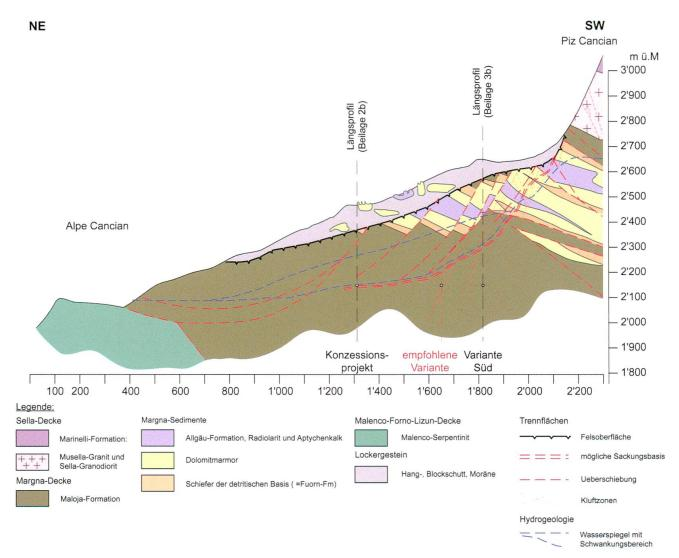
Fig. 6: Querprofil Cancian durch das Sackungsgebiet Cancian-Caral. Die Gebirgsstrukturen wurden aufgrund von geologischen Detailkarten und drei hybridseismischen Hangprofilen konstruiert. Aufgrund der Untersuchungsresultate wurde die Projektachse des Stollens aus dem Sackungsbereich nach Süden verschoben (vgl. Fig. 5).
