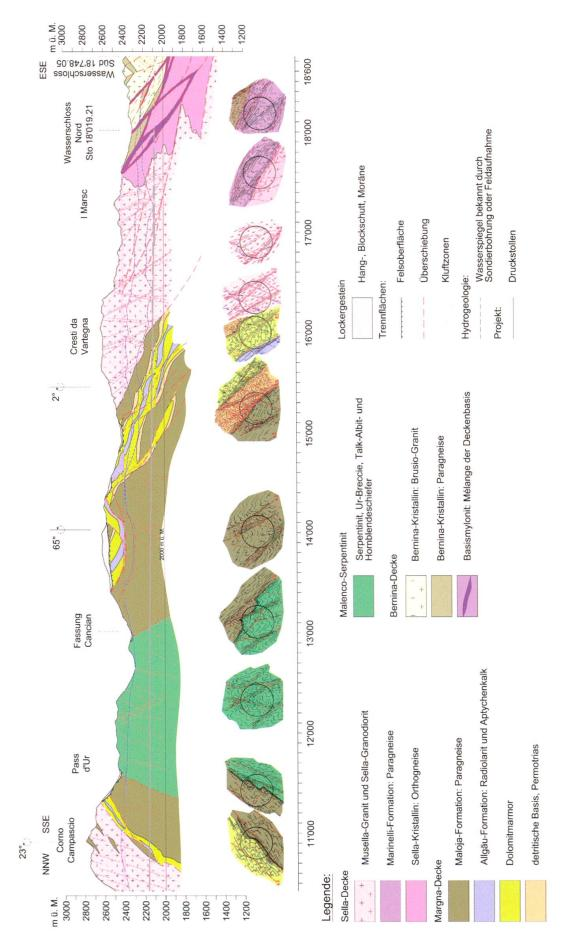
Fig. 5: Geologisch-geotechnisches Längsprofil Druckstollen Süd. Untere Bildreihe: Prognose von Strukturdetails an der lokalen Vortriebsbrust. In der entsprechenden Beilage zum Konzessionsprojekt ist unter dem Längsprofil die geotechnische Tabelle (Einstufung der Festgesteine und der Gefährdungen) gemäss der Normen SN 531 199 bzw. SIA 199 angefügt (BTG 2012, Ber. 5346-22).
