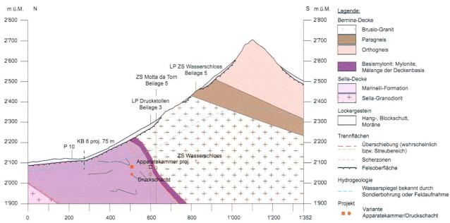
Fig. 7: Querprofil Wasserschloss – Apparatekammer I Marsc. In diesem Gebirgsabschnitt wurde eine Serie von 10 Hilfsprofilen aufgrund der geologischen Detailkarte mit Isohypsenkonstruktion des Basismylonites (vgl. Fig. 8) und vier Kernbohrungen à 100 m bis 336 m konstruiert. Aufgrund der detaillierten Erkenntnisse zum lokalen Gebirgsbau konnte die Position der Apparatekammer am Druckschachtkopf optimiert werden (abrücken aus dem tektonisierten Basismylonit; BTG 2013, Bericht 5346-31).
