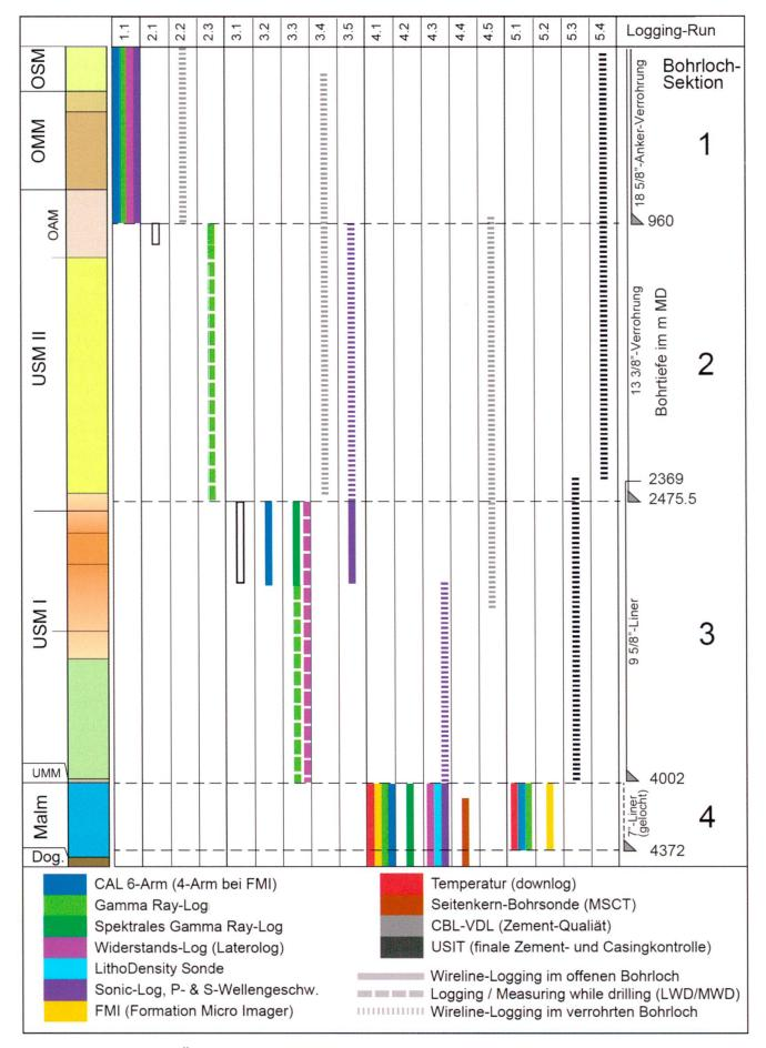
Fig. 6: St. Gallen GT-1: Übersicht über das ausgeführte geophysikalische Logging-Programm. Durchgezogene Balken = Wireline Logging; gestrichelte Linien = MWD-Logging; gepunktete Linien = durch die Verrohrung aufgenommene Messung.
