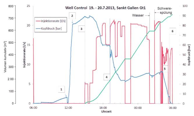
Fig. 12: Grafische Darstellung des Ablaufs der Ereignisse vom 19./20. Juli 2013. Grafik aus Wolfgramm et al. 2014, ergänzt. Rot = Injektionsrate, blau = Kopfdruck, grün = injitiertes Volumen kumulativ.
