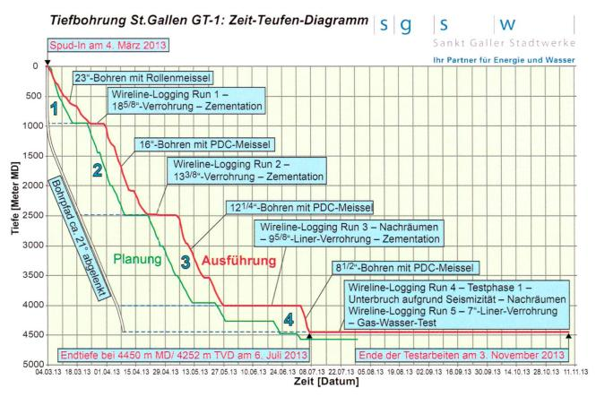
Fig. 5: Zeit/Teufen-Diagramm der Bohrung St. Gallen GT-1, mit Darstellung der wichtigsten Arbeitsphasen in den Bohrloch-Sektionen 1 bis 4 (grün = Planung, rot = Realisierung).
