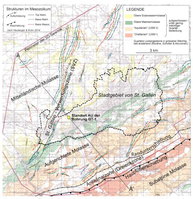
Fig. 2: Geologische Übersicht Stadtgebiet St. Gallen und Umgebung mit Perimeter der 3D-Seismik. Darstellung der kartierten Verwerfungen im Mesozoikum mit der St. Gallen-Verwerfungszone als vorrangiges Zielgebiet. Geologischer Profilschnitt A – A' siehe Fig. 3.
