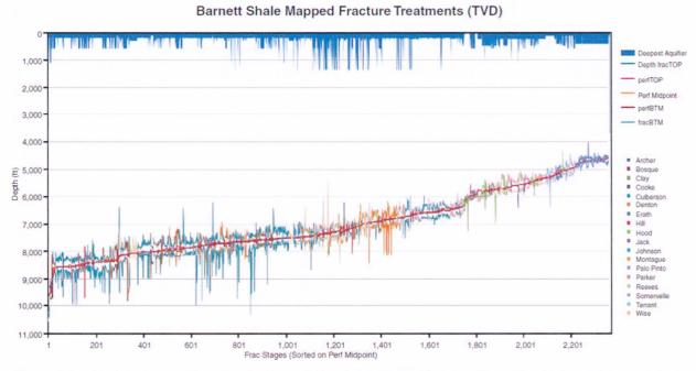
Fig. 3: Rissausdehung in «Barnett Shales», Texas (Fisher 2010). Mit mikroseismischen Messverfahren bestimmte Ausdehnung von Fracrissen in den Barnett Shales in the Fort Worth Basin in Texas (rund 2'400 Fracs).
