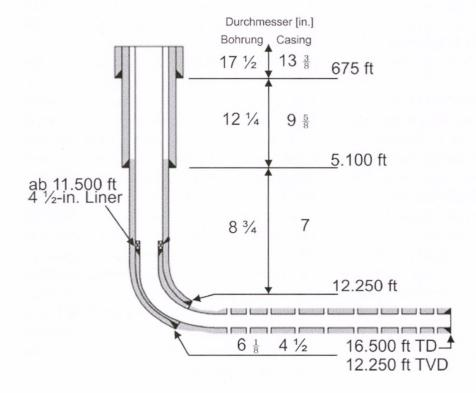
Fig. 2: Beispielhaftes Verrohrungsschema Horizontalbohrung (nicht massstäblich). TD: Länge der Bohrung gemessen vom Bohransatzpunkt (total depth); TVD: Vertikaler Abstand des Bohrlochtiefsten zum Bohransatzpunkt (true vertical depth); Massangaben: 1 ft = 0.3048 m; 1 in. = 2.54 cm (aus Meiners et al., 2012, nach Rohwer et al. 2006).
