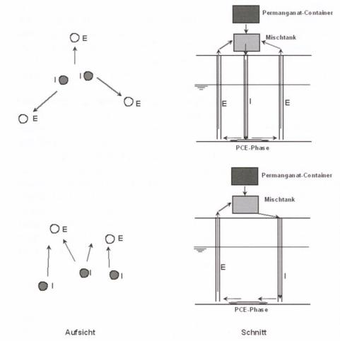
Fig. 7: Schematische Darstellung der beiden Hauptkonfigurationen für Injektions- und Extraktionspegel. Oben: Zentrale Anordnung der Injektionspegel. Unten: Obstromseitige Anordnung der Injektionspegel. Links jeweils eine Aufsicht der grundsätzlichen Anordnung der Pegel für die Injektion (I), und Extraktion (E); Rechts: Schnitte durch die beiden Anordnungen.
