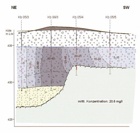
Fig. 20: Räumliche Verteilung der CKW-Konzentrationen in der Kontrollebene (Stand 20.2.2013). Die Zahlen in der Figur geben die pro ausgeschiedener Flächeneinheit mittlere CKW-Konzentration in µg/l wider.
