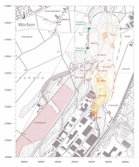
Fig. 15: Konzentrationsverteilungskarte für PCE nördlich abstromwärts Standortes (Daten vom Juni 2011). Die mit Sicherheit aus dem Standort stammende Fahne ist gestrichelt rot umrahmt. Die Quelle der weiter abstromwärts und in den beiden Fassungen beobachteten Kontamination (gestrichelte grüne Linie) ist noch unklar (siehe dazu Kap. 8). Die rot schraffierten Flächen stellen Altablagerungen gemäss dem Kataster der belasteten Standorte dar.
