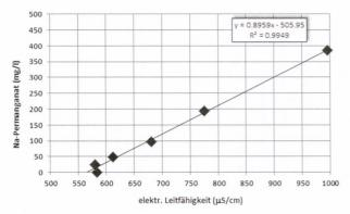
Fig. 8: Fig. 8: Korrelation zwischen elektrischer Leitfähigkeit und Na-Permanganat-Gehalt.
