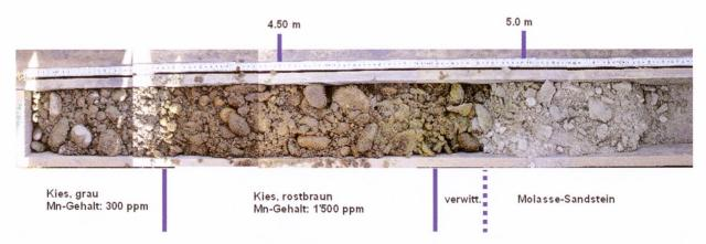
Fig. 17:Bohrkern Kb 12/1 (Tiefenbereich 4–5.5 m u. T.); rostbraune Verfärbung infolge Bildung von Mn-Oxid (semiquantitative Analysedaten aus mobiler XRF).
