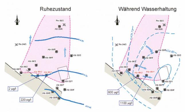
Fig. 4: Hydraulische Verhältnisse im Ruhezustand und während der GW-Absenkung.
