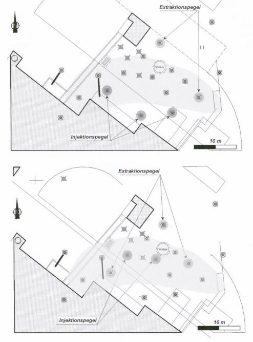
Fig. 10: Beispiele für die Anordnung der Injektions- und Extraktionspegel.
