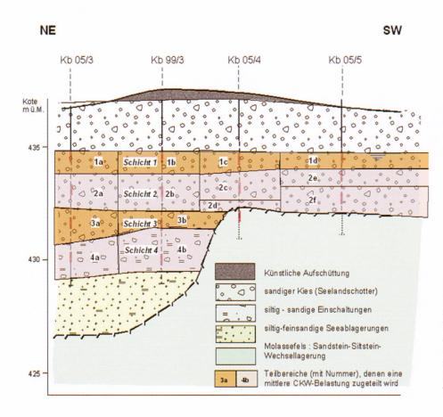
Fig. 19: Die Kontrollebene mit den 4 GW-Messstellen und ihre Unterteilung in Teilebenen. Jeder Teilebene wurden eine CKW-Konzentration, ein Gefälle und ein Durchlässigkeitsbeiwert zugeordnet.
