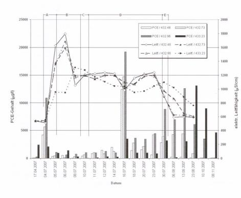
Fig. 9: Verlauf des PCE-Gehalts und der elektrischen Leitfähigkeit während der Injektion (Pilotphase) ca. 6 m abstromseitig der Injektionsstelle Kb 04/2. Multilevel-Probeentnahmekompartimente 25, 50, 75 und 100 cm ab Stauer (432.48, 432.73, 432.96 und 433.23 m ü. M.). Phase A: Injektion/Extraktion alternierend: Phase B: nur Extraktion; Phase C: kontinuierliche Injektion; Phase D: nur Extraktion (Zirkulation ohne Injektion).
