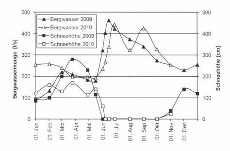
Fig. 3: Vergleich des zeitlichen Verlaufs der bei Seewli (2030 m ü. M.) durch das Institut für Schnee- und Lawinenforschung (SLF) gemessenen Schneehöhen mit dem Bergwasseranfall im Tunnel.
