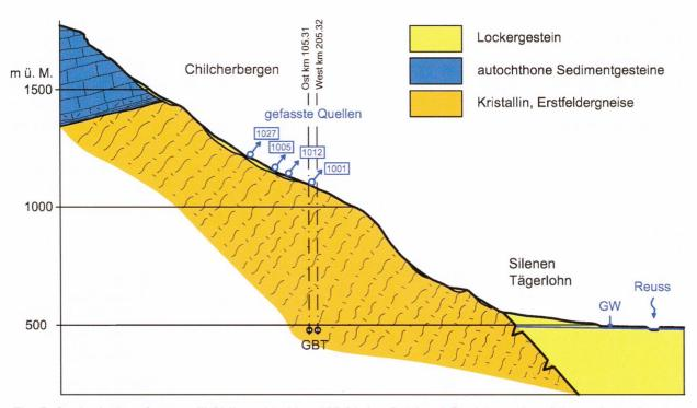
Fig. 5: Geologisches Querprofil Chilental bei km 105.31 des Gotthard-Basistunnels mit Lage der gefassten Quellen.
