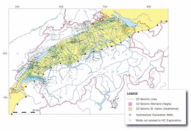
Fig. 1: Seismische Netzdichte und Tiefenbohrungen in der Schweiz. Die Energie-Industrie ist der wichtigste Lieferant für geologische Daten über den tiefen Untergrund der Schweiz. Trotzdem ist die tiefe Geologie des Landes sehr ungenügend bekannt.
