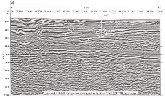
Fig. 2: Vergleich der Ergebnisse zweier unterschiedlicher EDV-Strategien zur Herleitung eines hochauflösenden reflexionsseismischen Tiefenprofils in einem Untersuchungsgebiet mit subhorizontalen Ablagerungsstrukturen und einfacher Verteilung der seismischen Ausbreitungsgeschwindigkeiten bis in 500 m Tiefe. Zu beachten ist, dass unterschiedliche Geschwindigkeitsverteilungen für die Laufzeit/Tiefenwandlungen verwendet wurden.
