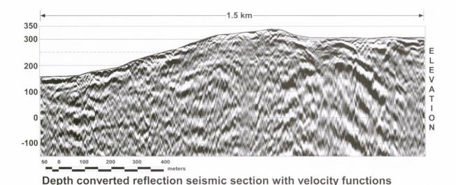
Fig. 4b: Reflexionsseismisches Tiefenprofil vom gleichen Datensatz wie in Fig. 3 aber ohne (rest)statische Korrekturen und mit direkter Laufzeit/Tiefen-Wandlung.
