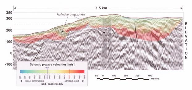
Fig. 4d: Vorschlag einer Interpretation des hybridseismischen Profils in Fig. 4c. Zu beachten ist die an mehreren Stellen gute Übereinstimmung der refraktionstomographisch und reflexionsseismisch abgebildeten Strukturen, z. B. bei der flach einfallenden Auflockerungszone in der linken Profilhälfte. Die visuelle Korrelation ist als gegenseitige Kalibration der beiden Auswertungsverfahren zu betrachten und eine Hilfe bei der geologisch-geotechnischen Interpretation.
