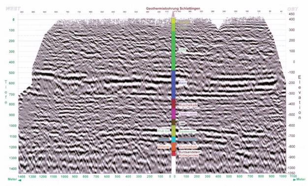
Fig. 1: Reflexionsseismisches Tiefenprofil über die Geothermiebohrung bei Schlattingen TG, erstellt mit einem Fallgewicht als seismische Quelle und registriert mit einer Registrierapparatur von 360 Datenkanälen, d. h. mit 360 aktiven Geophonstationen in Abständen von 2.7 m.
