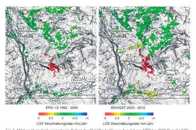
Fig. 5: Mittlere Verschiebungsrate im Gebiet der Chli Windgällen in den Jahren 1992 bis 2000 (Satellit ERS; links) und 2003 bis 2010 (Satellit ENVISAT; rechts). Massstab ca. 1: 80'000. Der schwarze Pfeil markiert einen Punkt, von dem die Verschiebungsdaten in einer Zeitreihe dargestellt sind (Fig. 6, 7).
