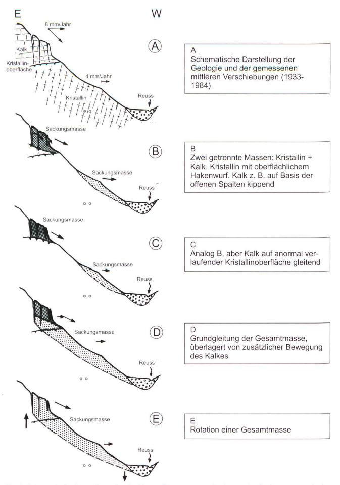
Fig. 3: Schematische Darstellung der denkbaren Bewegungsmechanismen der Sackungsmasse in der Westflanke der Chli Windgällen (Schemas A bis E; aus Schneider 1984, leicht modifiziert). Hinzugefügt wurden die beiden Tunnelröhren des neuen Gotthard-Basistunnels.
