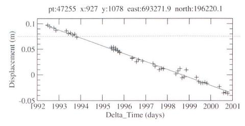
Fig. 10: Zeitreihe der Verschiebung des in Fig. 9 mit Pfeil markierten Punktes im hinteren Gruontal für die Periode 1992–2000. Die mittlere Verschiebung betrug rund 15.6 mm/Jahr.
