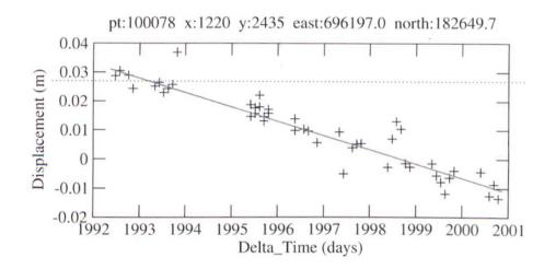
Fig. 6: Zeitreihe der Verschiebung des in Fig. 5 markierten Punktes im Zeitraum zwischen 1992 und 2000 (ERS-Satellit). Die mittlere Verschiebung betrug rund 5 mm/Jahr.
