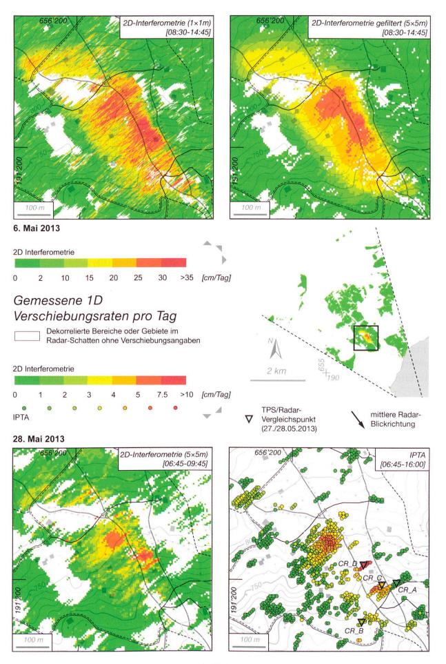
Fig. 2: Karten der gemessenen Bewegungsraten in Radar-Blickrichtung. Positive Werte zeigen Bewegung zum Radar hin an. Achtung: unterschiedliche Farbskalierungen der Karten vom 6. und vom 28. Mai. Details zur Kartenerstellung sind dem Kapitel «Interferometrische Prozessierung» zu entnehmen.
