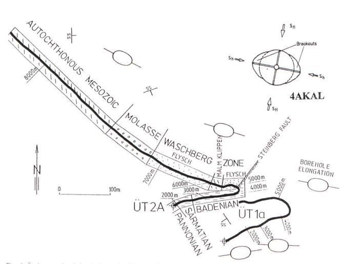
Fig. 6: Änderung der Azimutallage der Ellipsen-Hauptachsen mit der Teufe und der Standzeit.
