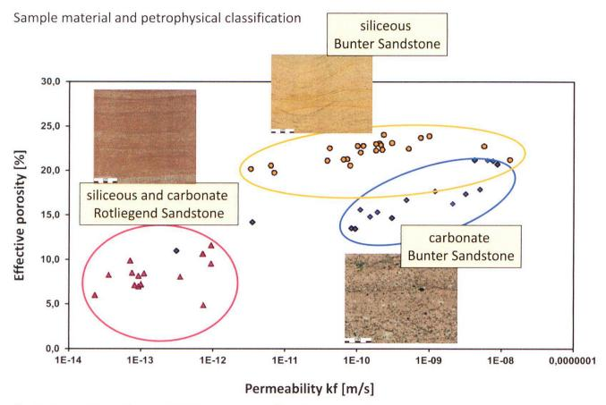
Fig. 1: Porosität vs. Permeabilität untersuchter Speichersandsteine.
