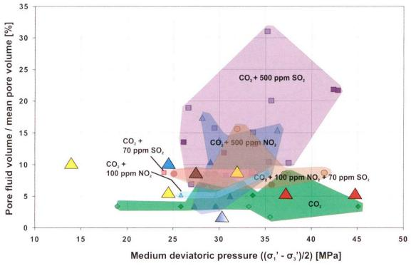
Fig. 5: Anteil des von verschiedenen  ${\rm CO_2}$ -Fluiden genutzten Porenraums während der deviatorischen Belastung im Triaxialtest.
