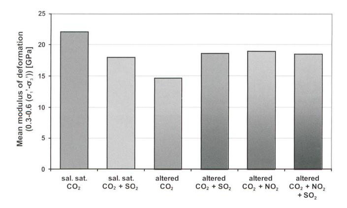
CO<sub>2</sub>-fluid / rock- interaction: Mechanical weakening of the Rotliegend-Sandstone Fig. 4: Veränderungen des Verformungsmoduls infolge Wechselwirkung mit verschiedenen CO<sub>2</sub>-Fluiden.
