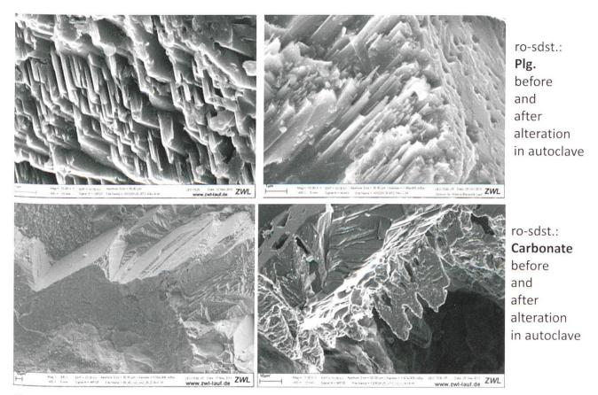
Fig. 2: REM-Aufnahmen von Plagioklas (oben) und Karbonatzement (unten), jeweils vor (links) und nach (rechts) experimenteller Alteration.
