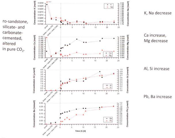
Fig. 3: Chemische Veränderung im Porenfluid eines Rotliegend-Sandsteins während experimenteller Alteration.
