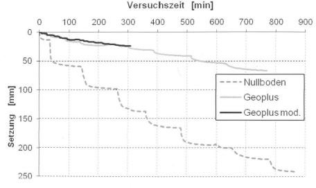
Fig. 7: Zeit-Setzungslinie für die Leithaschotter.
