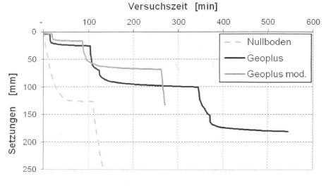
Fig. 15: Zeit-Setzungslinie für Löss.
