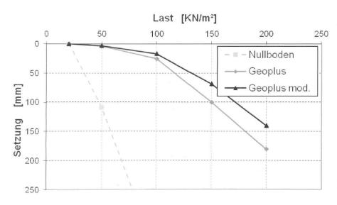
Fig. 14: Last-Setzungslinie für Löss.
