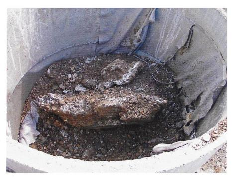
Fig. 8: Injektionsbereich in Leithaschotter.
