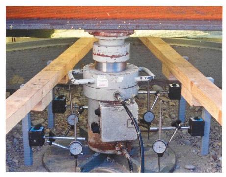
Fig. 4: Hydraulikzylinder und Lastplatte mit angesetzten Messuhren.
