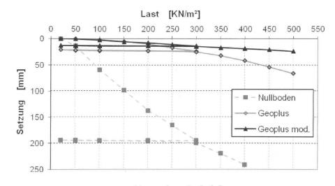
Fig. 6: Last-Setzungslinie für die Leithaschotter.
