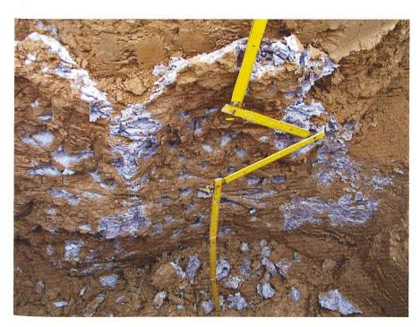
Fig. 16: Lamellenförmige Ausbreitung des Injektionsmittels in Löss.
