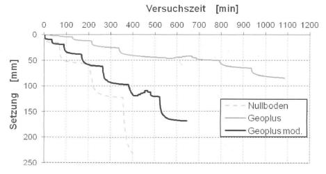
Fig. 11: Zeit-Setzungslinie für Tegel.
