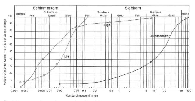
Fig. 2: Kornsummenkurven der verwendeten Materialien.
