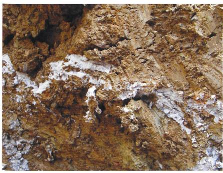
Fig. 13: Lammellenförmige Ausbreitung im Tegel.
