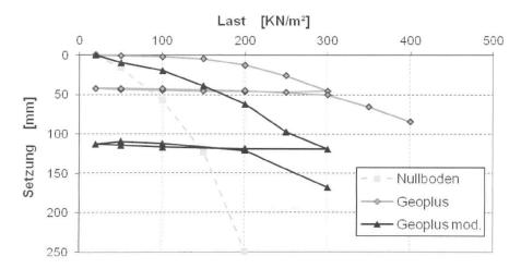
Fig. 10: Last-Setzungslinie für Tegel.
