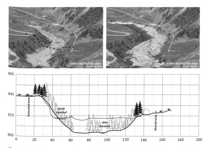
Fig. 6: Geschiebeablagerungen im Aarebett: Zustand 2009 [links] und 2011 [rechts], dargestellt im Orthofoto [oben] sowie im Querprofil im Bereich Aegersteinkurve [unten] (Hählen 2012b).
