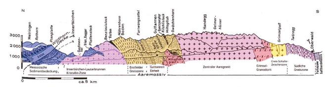
Fig. 2: Geologisches Profil zwischen Meiringen und Oberwald entlang der Grimselpassstrasse. Das Ritzlihorn bei Guttannen liegt in der Guttannen-Einheit und wird durch stark verschieferte Biotit-Plagioklas-Gneise aufgebaut (modifiziert nach Gwinner 1978).
