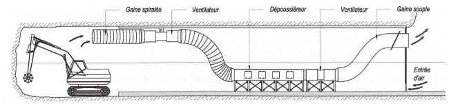
Fig. 4.5: Principe d'évacuation des poussières.
