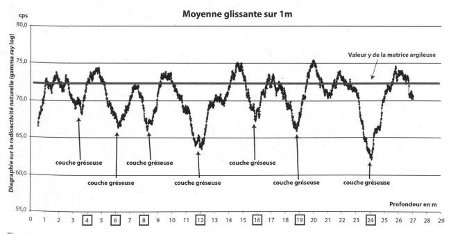
Fig. 3.3: Exemple de diagraphie gamma-ray.
