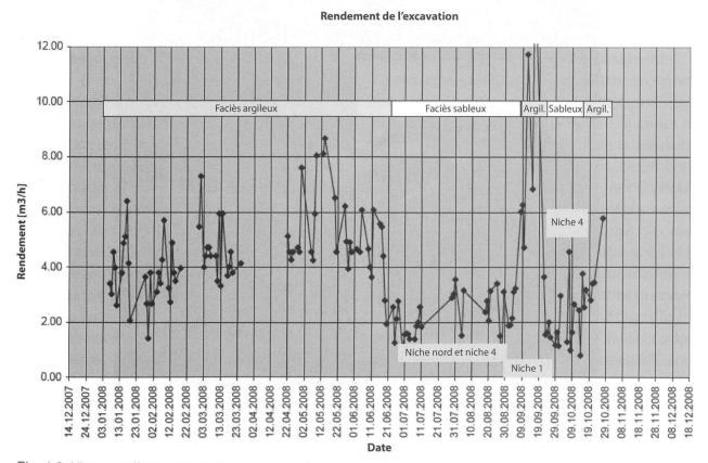
Fig. 4.3: Vitesses d'avancement.
