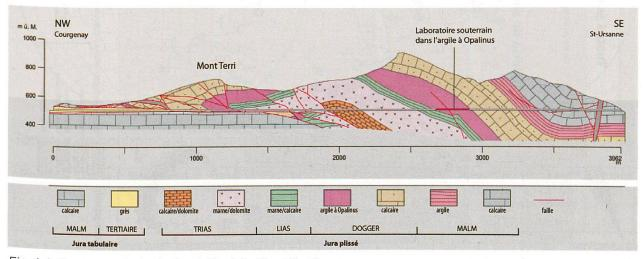
Fig. 1.1: Coupe verticale de l'anticlinal du Mont Terri.
