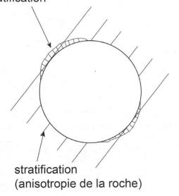
Fig. 1.4: Rôle de l'anisotropie, matérialisée par les plans de stratification, sur le développement de hors profils.
