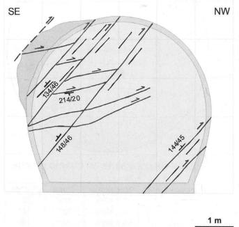
écaillage au point de tangence entre le profil d'excavation et les plans de stratification
