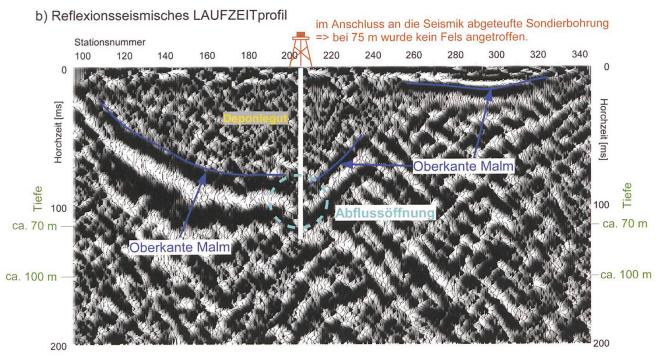
Fig. 7: Hybridseismische Erkundung einer als Deponie genutzten Doline zur Bestimmung der Abflussöffnung. Auf dem reflexionsseismischen Profil im unteren Bild ist die Öffnung deutlich zu erkennen. Eine im Anschluss an die Seismik durchgeführte Bohrung hat bei einer Tiefe von 75 m keinen Fels angetroffen.
