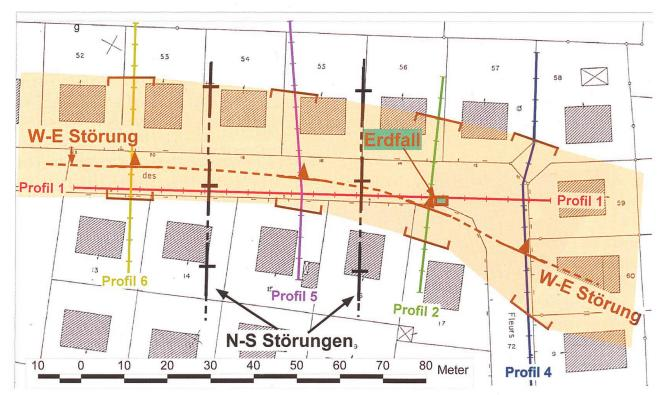
Fig. 6: Gesamtsituation nach Auswertung der 6 seismischen Profile bei Altkirch. Der Erdfall und sich abzeichnende weitere Instabilitäten im Untergrund befinden sich am Schnittpunkt eines E-W orientierten Grabenbruchs mit einer N-S verlaufenden Störungszone.
