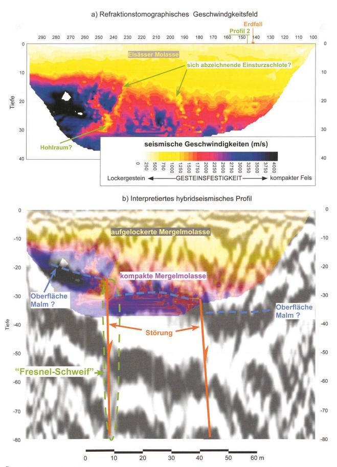
Fig. 5: E-W Profil 1 bei Altkirch, mit seismisch gut erkennbaren, weiteren sich abzeichnenden Einsturzschloten. Diese stehen in Zusammenhang mit zwei in N-S Richtung verlaufenden Brüchen.
