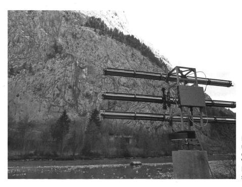
Fig. 1: Blick auf die Simmenfluh (Kanton Bern) mit dem Radargerät GPRI im Vordergrund. Unten an der Felswand ist die Nationalstrasse A6 erkennbar.
