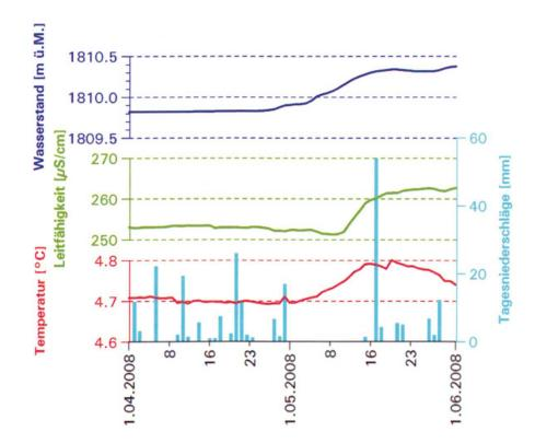
Fig. 11: Messung von Pegel, Leitfähigkeit und Temperatur im Aquifer über dem Quellhorizont.
