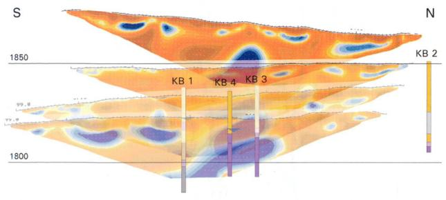
Fig. 7: Räumliche Ansicht der Profile der geoelektrischen Tomographie, Spuren GE1 bis GE4 mit Bohrprofilen KB1 bis KB4 (vgl. Situation in Fig. 5). (Blau: geringer Wiederstand [ca. 200–350 Ohm.m], braun: hoher Wiederstand [ca. 1000–1500 Ohm.m]).
