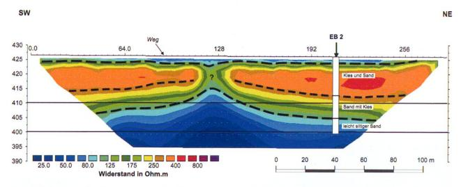
Fig. 1: Widerstands-Tomographie-Profil mit Bohrergebnis in der Lockergesteinsfüllung des Reusstals. Profillänge 284 m, Elektrodenabstand 4 m (Standort: Emmenfeld, LU).
