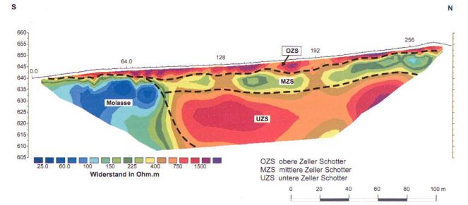
Fig. 6: Kiesprospektion mit 2D-Tomographie. Profillänge 284 m, Elektrodenabstand 4 m (Standort: vorderes Lutherntal, Zell, LU).
