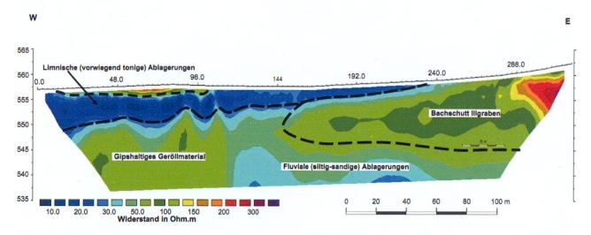
Fig. 2: Untersuchung von feinkörnigen setzungsempfindlichen Sumpf- und Seeablagerungen. Profillänge 320 m, Elektrodenabstand 3 m (Standort: Pfyngut, VS).
