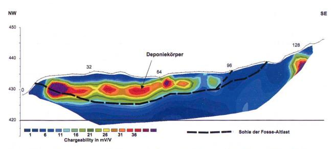
Fig. 4: Altlastuntersuchung mit 2D-Tomographie (Induzierte Polarisation). Profillänge 140 m, Elektrodenabstand 2 m (Standort: En Colliare, Penthaz, VD, Altlastkörper Fosse).
