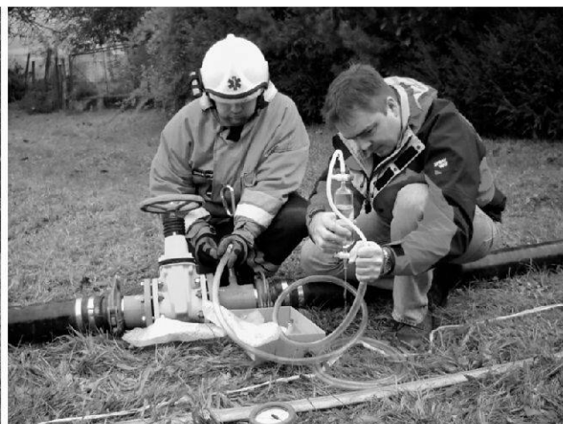
Fig. 4: Links: Erdgasaustritt nach der kontrollierten Entzündung durch die Feuerwehr. Rechts: Gasbeprobung am Absperrschieber der Spülungsleitung. Für eine folgende Druckmessung wurde nach Abschluss der Probenahmen ein Manometer (im Vordergrund des Bildes) an die Abzweigung geschraubt.
