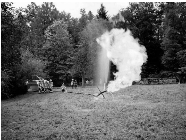
Fig. 4: Links: Erdgasaustritt nach der kontrollierten Entzündung durch die Feuerwehr. Rechts: Gasbeprobung am Absperrschieber der Spülungsleitung. Für eine folgende Druckmessung wurde nach Abschluss der Probenahmen ein Manometer (im Vordergrund des Bildes) an die Abzweigung geschraubt.
