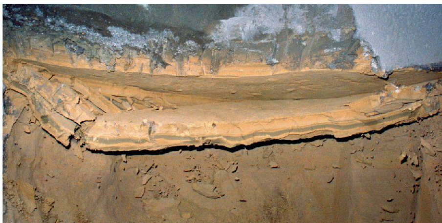
Fig. 6: Grenzbereich eiszeitliche Seebodenlehme/Sandlage; Verhalten des Lockergesteins beim Ausbruch der Sandlage [spontane, plattenartige Niederbrüche der Seebodenlehme innert einiger Minuten], Bildhöhe circa 1 m [Foto S. Frank].
