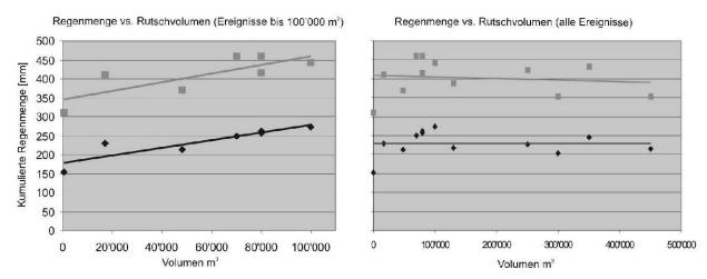
**Fig. 3:** Regenmengen vs. Rutschvolumen. Links: Rutschungen mit Volumina bis 100'000 m³, rechts: alle Ereignisse. Kumulierte Niederschläge ab 19.8.2005 bis Ereignisauslösung (schwarz), ab 1.8.2005 bis Ereignisauslösung (grau).
