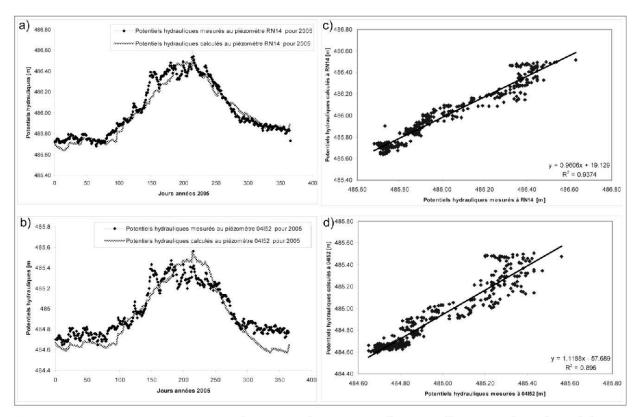
Fig. 5: Potentiels hydrauliques mesurés et calculés aux points (avec corrélations linéaires) de référence RN14 et 04/52.
