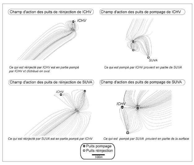
Fig. 6: Interférence entre les puits de prélèvement et de réinjection de ICHV et SUVA.
