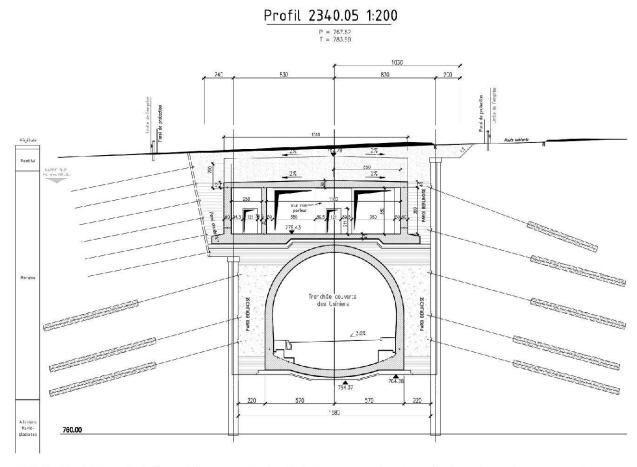
**Fig. 7:** Profil type de la tranchée couverte des Usiniers en section fermée. En raison du manque d'espace disponible en surface, le soutènement est réalisé verticalement par une paroi berlinoise avec des pieux en béton.
