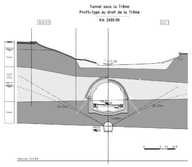
**Fig. 3:** Profil type du tunnel au droit de la Trême. La galerie de drainage est située sous le radier du tunnel. Des forages rayonnants obliques constituent le dispositif de rabattement. Le toit de la nappe rabattue est schématisé en traits pointillés. Moins de 4 m sépare la voûte du tunnel du lit de la rivière (la Trême).
