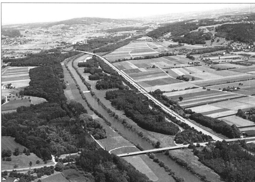
Fig. 3: Heutiger Thurlauf bei Pfyn (Blick flussaufwärts): Begradigtes Mittelgerinne, begleitet von Ufergehölzstreifen, Hochwasserdamm, Binnnekanal und Autobahn. Das Vorland wird land- und forstwirtschaftlich genutzt. Foto Chr. Herrmann, BHAtteam, Frauenfeld
